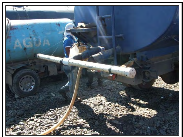
Fotos 7.2.3-2. Tipo de camiones cisternas con regaderas utilizadas para el humedecimiento de viales.
