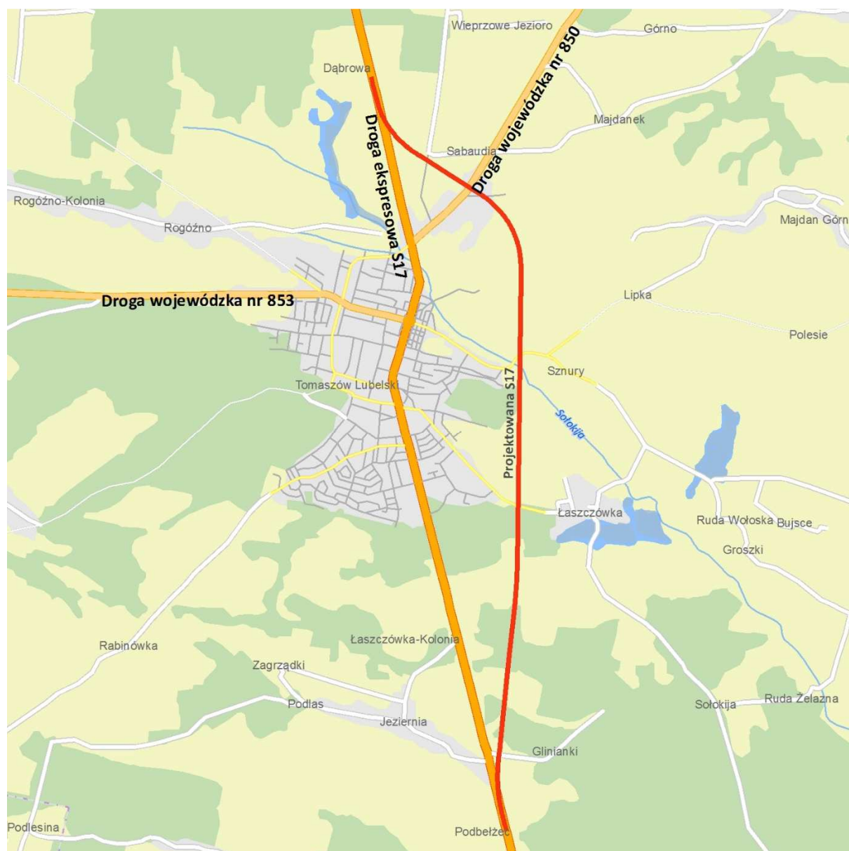
Rysunek 12. Lokalizacja istniejącego przebiegu DK17 i planowanej obwodnicy Tomaszowa Lubelskiego.
