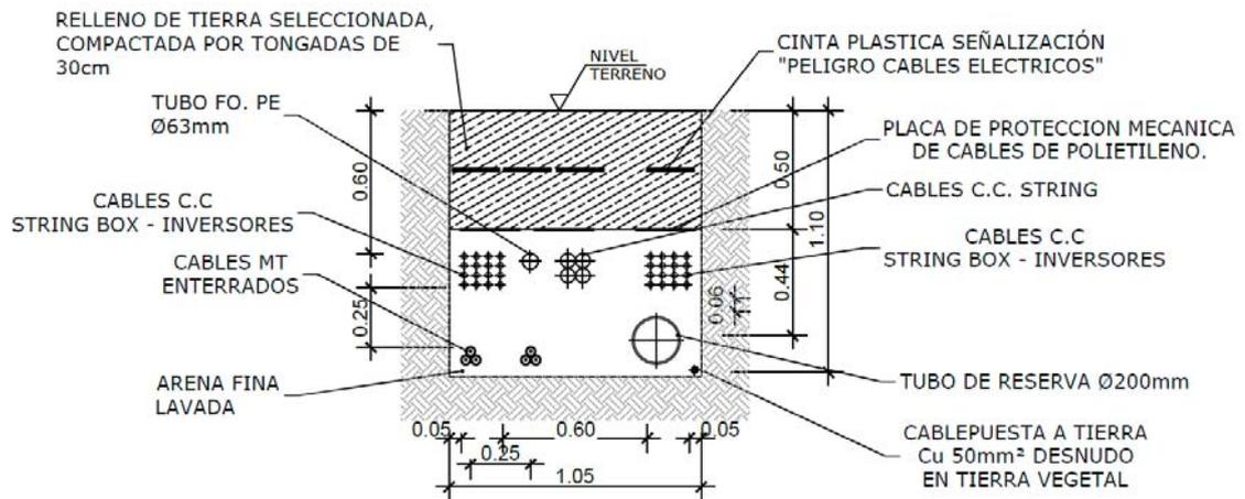
**Figura 10:** Detalle de zanja perimetral. Fuente: promotor
