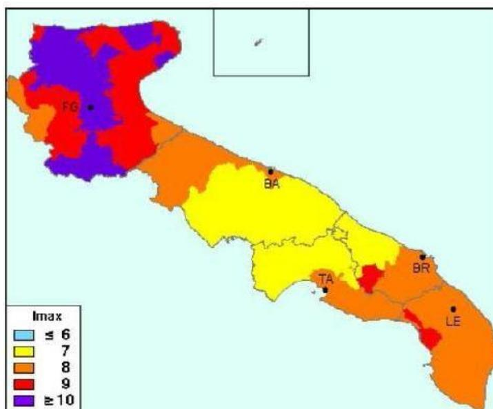
**Figura 8-3:Puglia, mappa del livello delle soglie di danno.  $I_{m}<6$  danni pressoché inesistenti,  $I_{max}>10$  danni elevati alle costruzioni**
