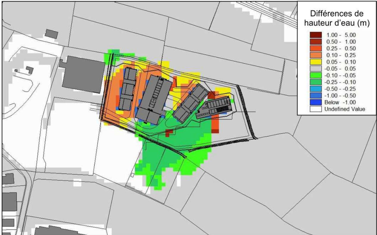
**Figure 49 : Différences de hauteur d'eau maximale entre l'état projet et l'état actuel (Source : INGEROP, septembre 2014)**
