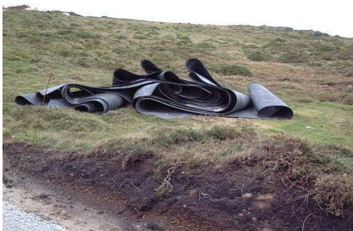
Figura 54 –Detalle de manta de goma utilizada en las voladuras
