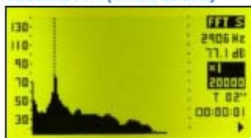
Este módulo de análisis frecuencial extendido del sonómetro **SC260** incorpora 2 modos de medición: modo análisis frecuencial extendido en 1/3 de octava y modo análisis frecuencial de banda estrecha FFT (Fast Fourier Transform).
