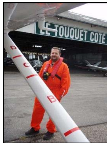
Matérialisation des couloirs sur les haubans de l'avion (source : Biotope)
