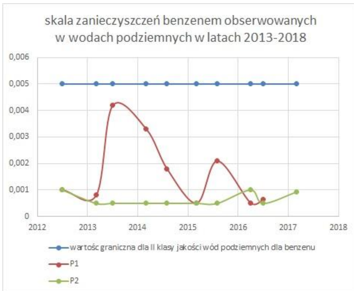
Rysunek 17. Skala zanieczyszczeń benzenem obserwowanych w wodach podziemnych w latach 2013-2018.
