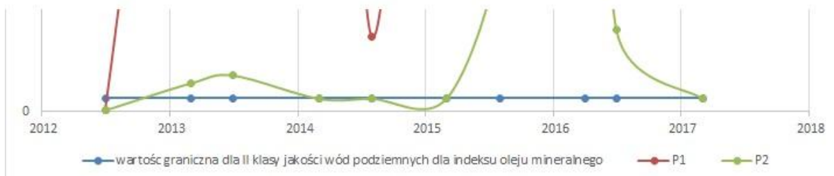
Rysunek 16. Przekroczenia indeksu oleju mineralnego powodujące nieosiągnięcie dobrego stanu wód podziemnych notowane na piezometrach P1 i P2.
