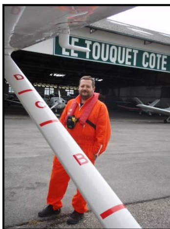
Figure 7 : Matérialisation des couloirs sur les haubans de l'avion (BIOTOPE)
