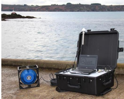
Figure 8 : Exemple d'instrumentation acoustique active portable (source Quiet-Oceans)
