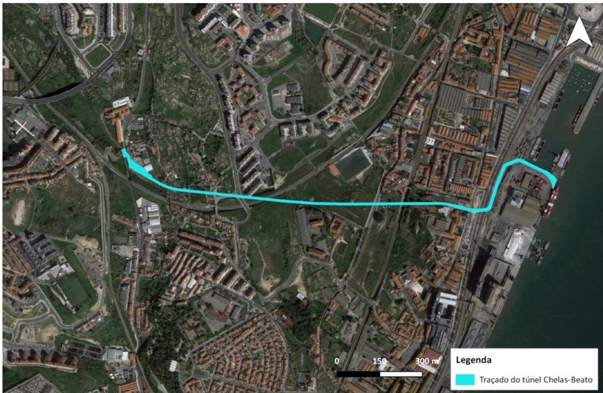
Figura 7 - Traçado geral do túnel de drenagem Chelas-Beato (Consórcio Hidra/Engidro, 2016)
