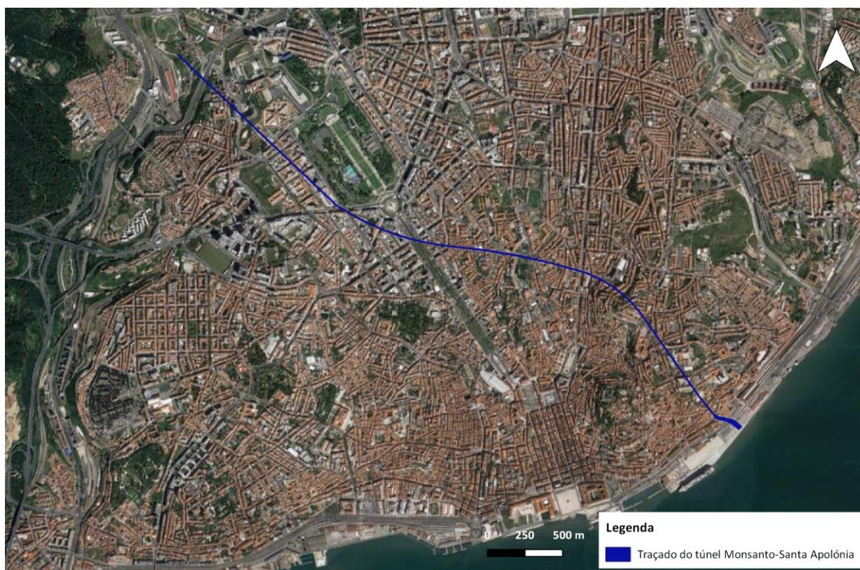
Figura 6 - Traçado geral do túnel de drenagem Monsanto-Santa Apolónia (Consórcio Hidra/Engidro, 2016)
