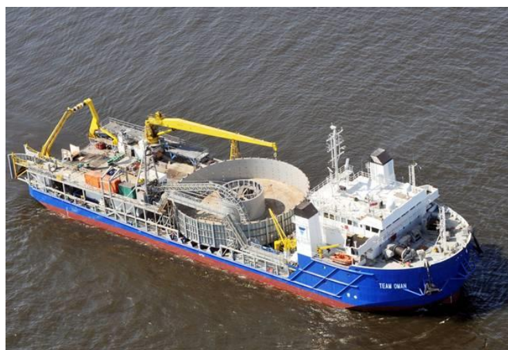
Figure 65 : Illustration d'un navire posant des câbles (Source : Global Marine System)
