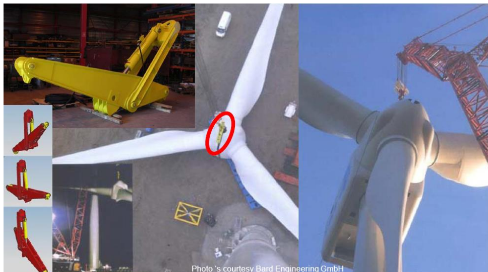
Figure 41 : Outil de basculement du rotor, de 165 t de capacité (source Gusto MSC).
