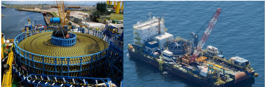
Figure 43 : Barge équipée d'un carrousel (source DONG Energy).
