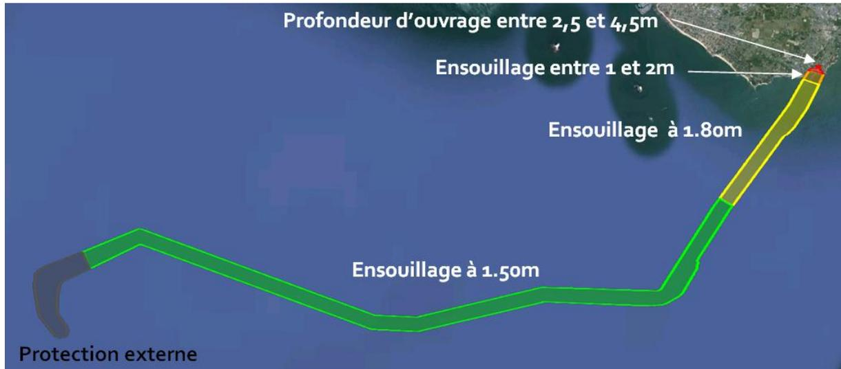
Figure 10 : objectifs de protection des câbles sous-marins (\*)
