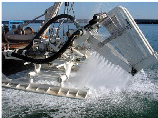
Figure 13 : exemple de water jetting
