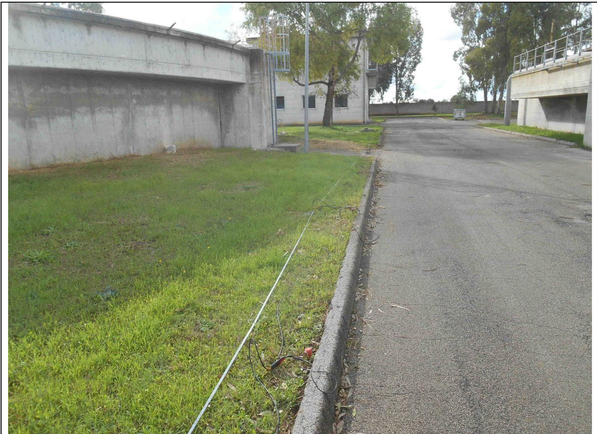
Esecuzione indagine sismica a rifrazione n.1
