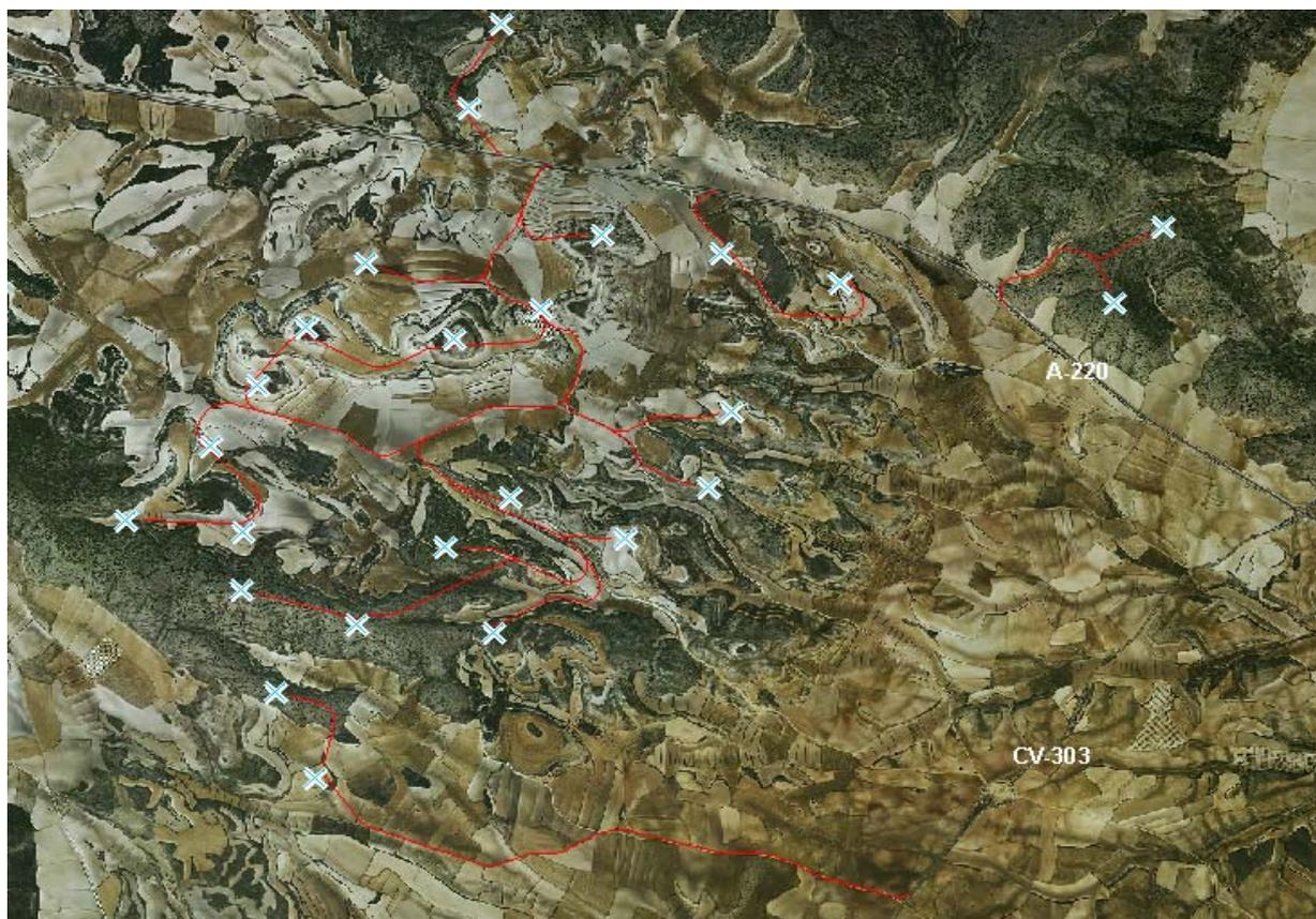
Fig. 10. Configuración inicial parque eólico "Argovento". Las aspas representan la ubicación de los 25 aerogeneradores previstos, mientras que en rojo se representa el trazado de los viales del parque
