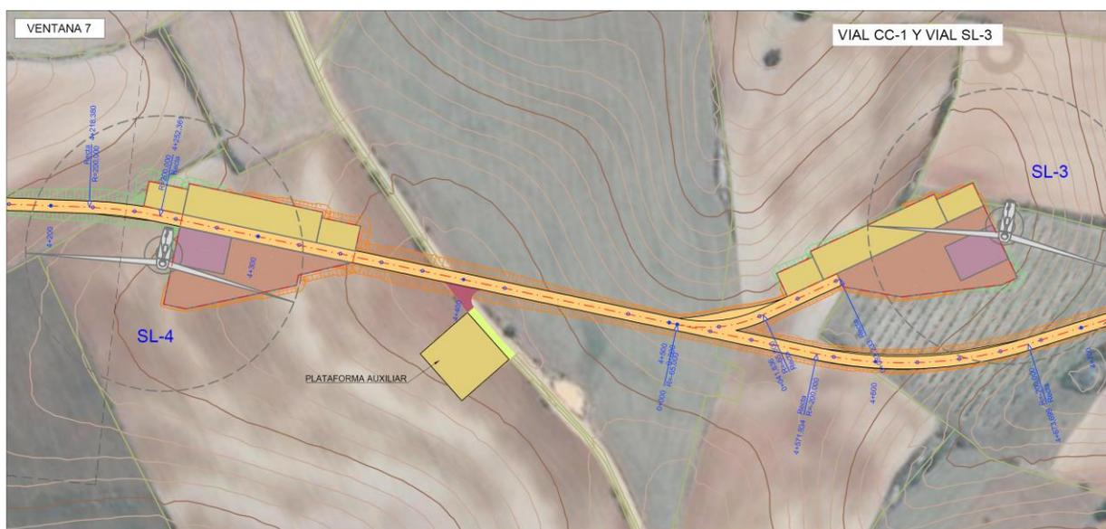
Figura 7 Propuesta de la alternativa 2 para el emplazamiento de la plataforma de instalaciones auxiliares
