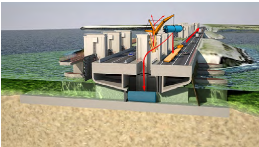
Afbeelding 6.1 Illustratie uitklapbare kraan vanuit de torens
