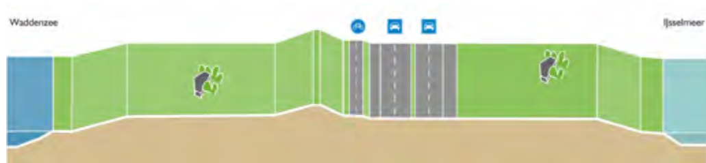
Afbeelding 2.5 Dwarsdoorsnede dijklichaam Robbenplaat
