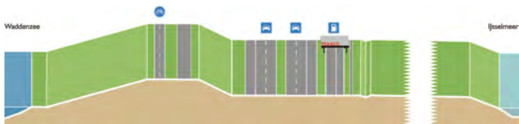
Afbeelding 2.7 Dwarsdoorsnede dijklichaam Breezanddijk
