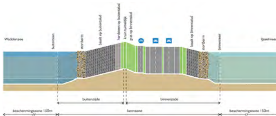
Afbeelding 2.3 Zones/onderdelen van het dijklichaam
