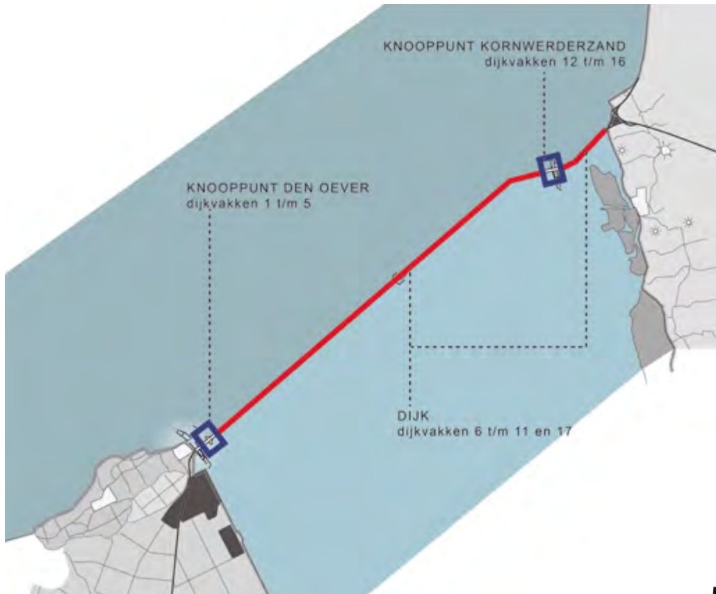
1.1 Afsluitdijk met voor onderscheid in dijk en knooppunten
