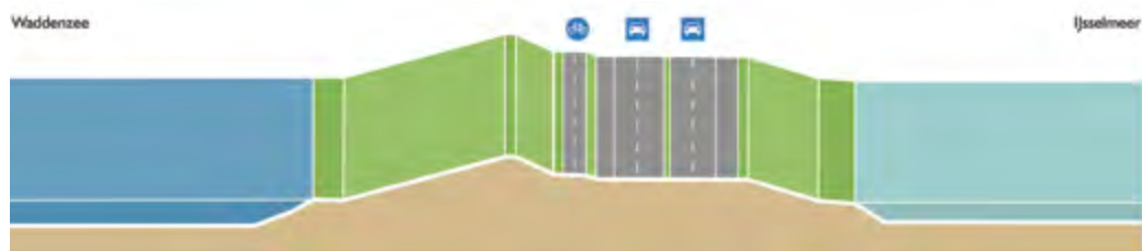
Afbeelding 2.4 Dwarsdoorsnede dijklichaam Den Oever - Kornwerderzand
