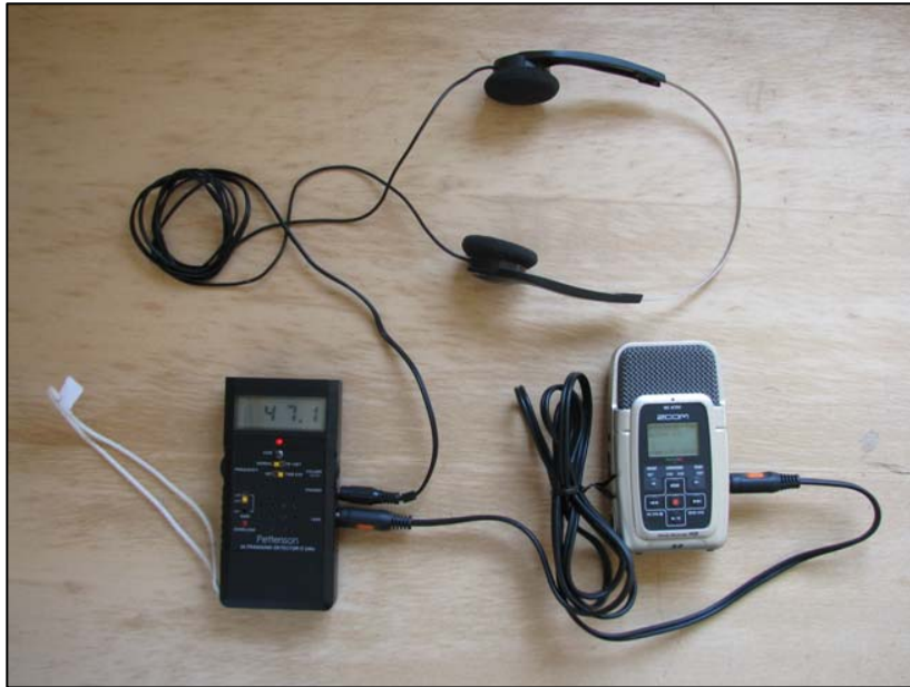
Abbildung 2-6: Ausrüstung zur Aufnahme von Fledermausrufen: Ultraschalldetektor (Pettersson D-240x) und Aufnahmegerät (Zoom H2).
