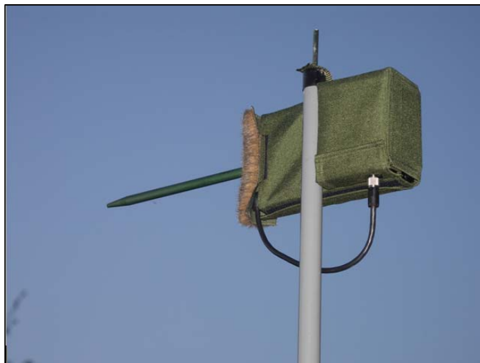
Abbildung 2-7: Automatische Registriereinheit „Batcorder“ (ecoObs, Nürnberg).
