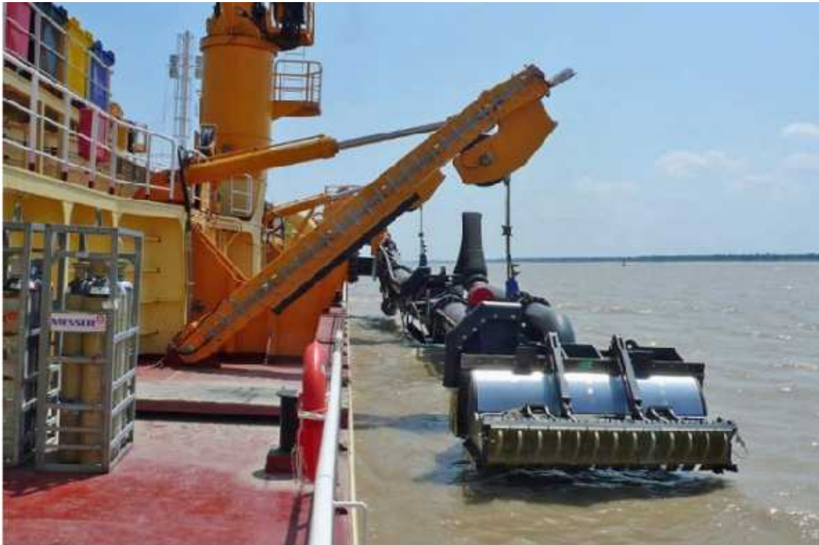
Figure II - 14 : Photo de l'élinde traînante d'une drague en marche (source: afcan.org)
