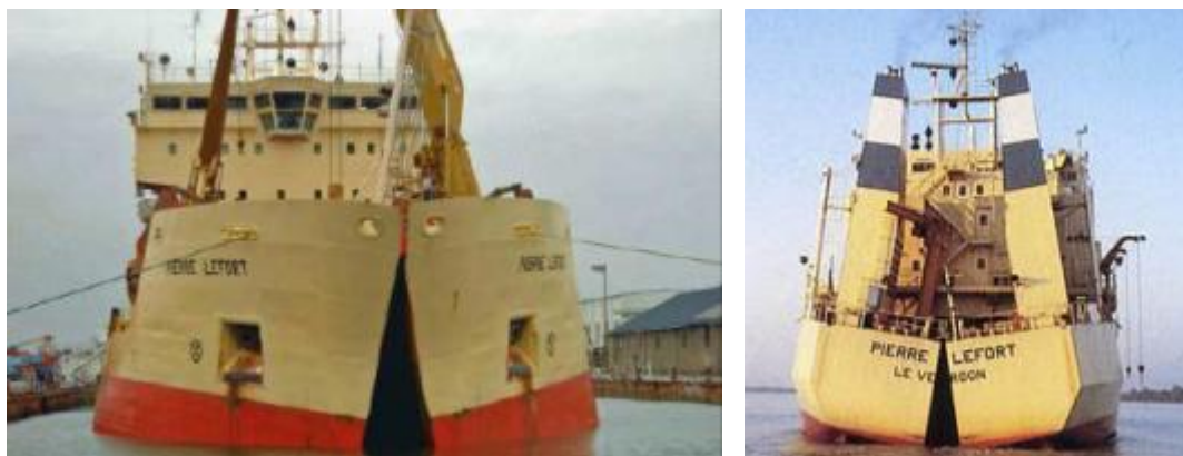
Figure III - 70 : Photos de la drague fendable Pierre Lefort
