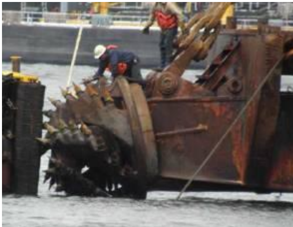
Figure III - 64 : Schémas d'un drague hydraulique aspiratrice refouleuse stationnaire (sources : larousse.fr, en haut, et ghentdredging.be, en bas) et photo d'une d'une petite drague aspiratrice (source Antea Group)
