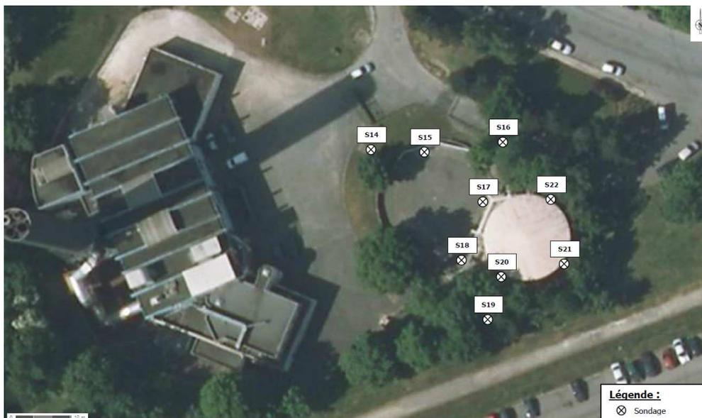
Figure 12 : Schéma d'implantation des sondages de la zone des existants – État actuel
