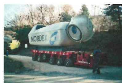
Transport de la nacelle
