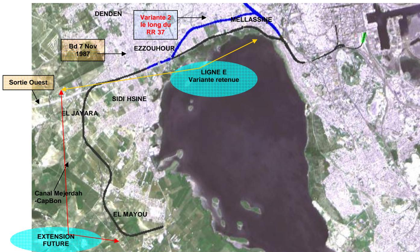
Figure 3 : Tracés de la variante retenue de la ligne E et de sa future extension
