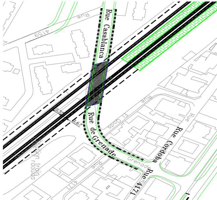
La structure de l'ouvrage est de type passage inférieur en cadre fermé (PI-CF) de portée 9 m, sa longueur totale est de 60 m. L'importance de cette longueur est dictée par le biais important que présente l'axe de l'ouvrage par rapport à la ligne RFR.
