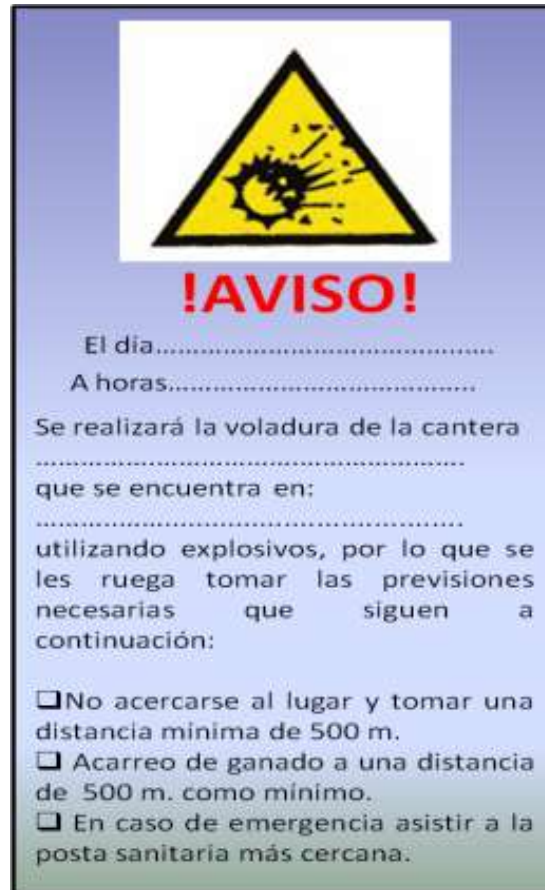
Figura 14.33 Cartilla informativa de voladura controlada
