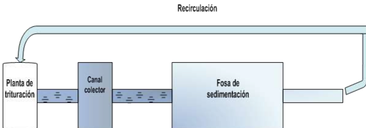
Figura 14.24 Sistema de tratamiento en la planta de trituración de agregados
