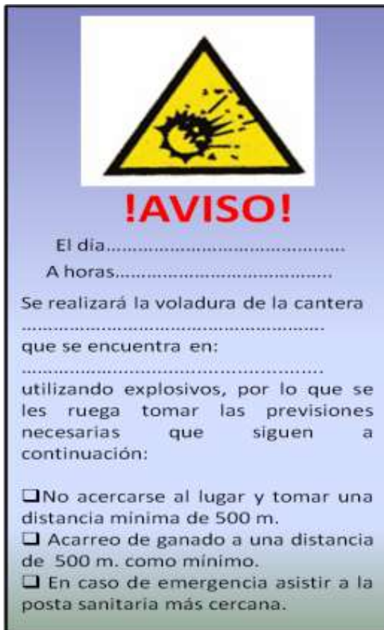
Figura 14.10 Cartilla informativa de voladura controlada
