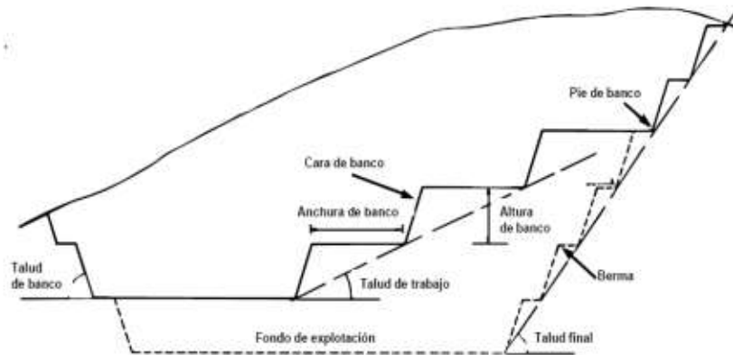
Figura 14.29 Esquema de corte de taludes para canteras
