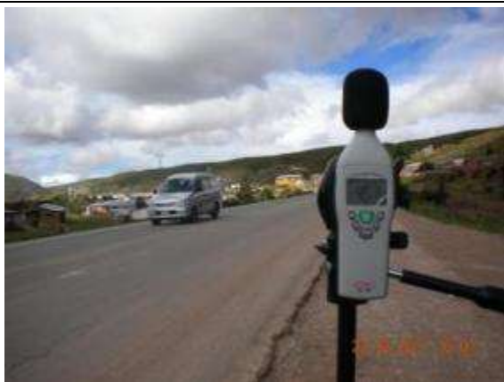
Foto 5.24: Medición de ruido en la población Pongo (Prog. 11+500)
