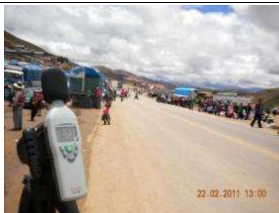
Foto 5.21: Medición de ruido en la población de Confital (Prog. 0+200)
