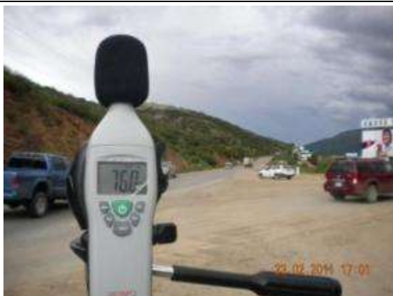
Foto 5.30: Medición de ruido en el Puente la Angostura (Paralelo a la Prog. 0+600)
