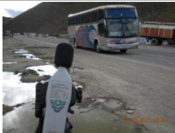
Foto 5.17: Medición de ruido en la población Lequepalca (Prog. 28+300)
