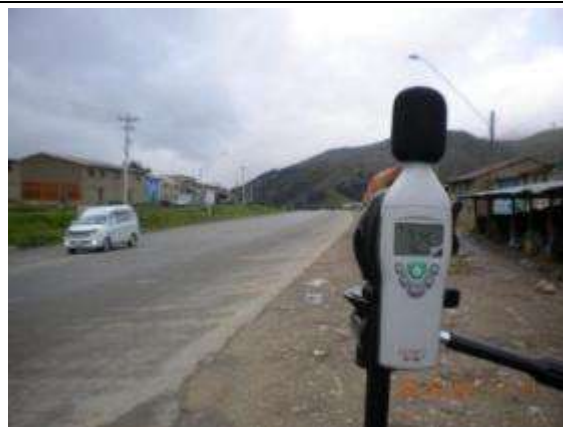
Foto 5.31: Medición de ruido en la población de Aguirre (Prog. 40+243)
