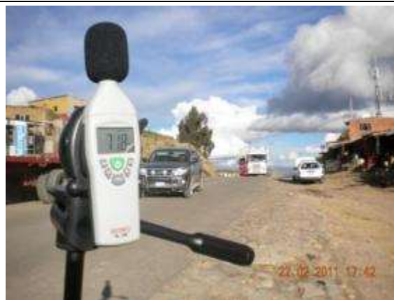
Foto 5.25: Medición de ruido en la población Bombeo (Prog. 0+400)
