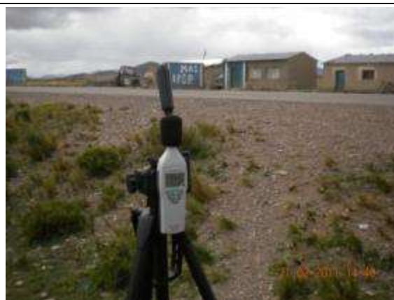
Foto 5.15: Medición de ruido en la población Villa Pata (Prog. 5+700)
