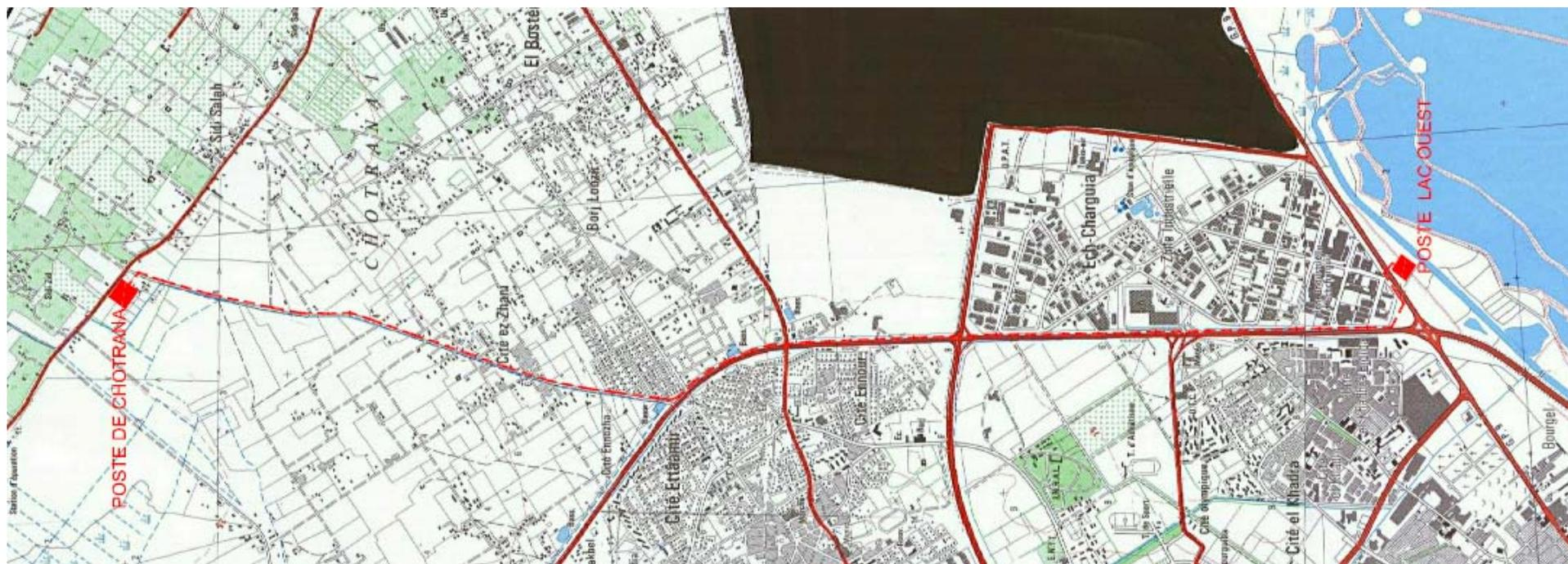
Figure 3 : Tracé de liaison 90 kV – 160 MVA Lac Ouet – Chotrana (8.6 km)
