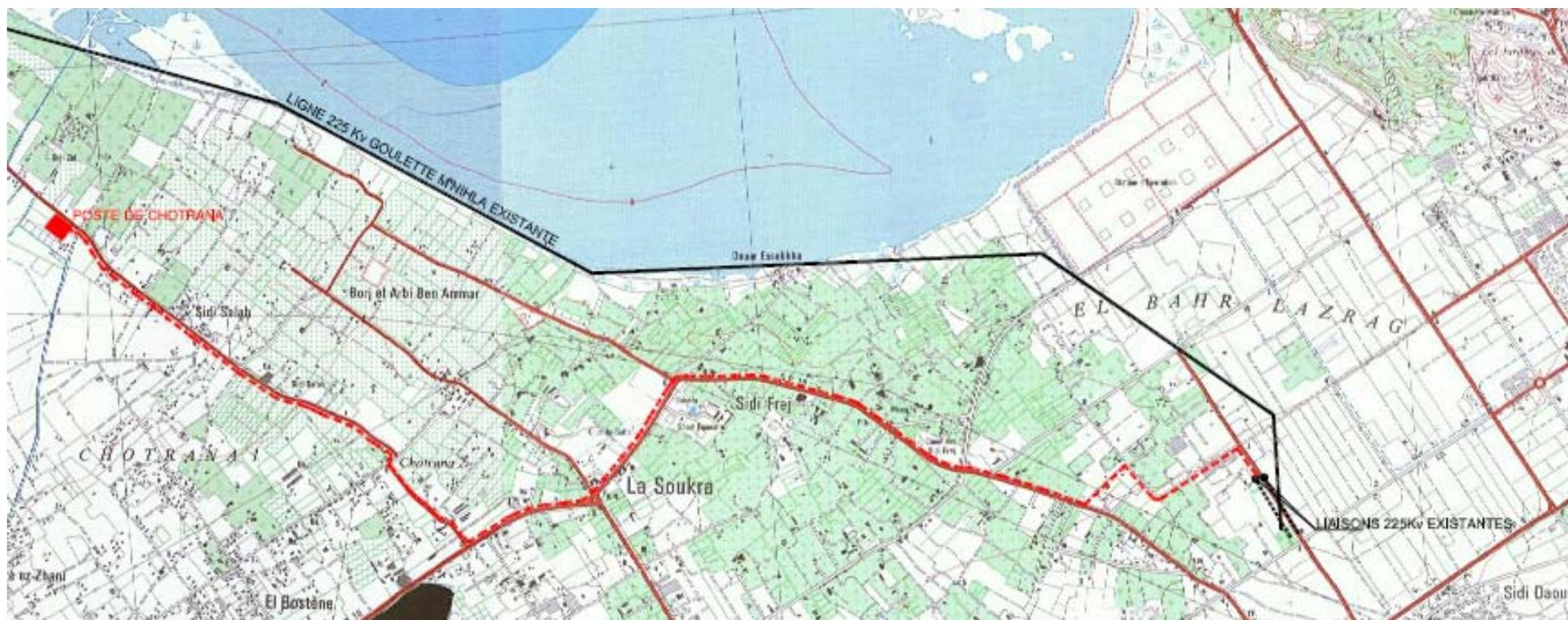
Figure 1 : Tracé deux liaisons 225 kV Chotrana – Kram (2x10 km)
