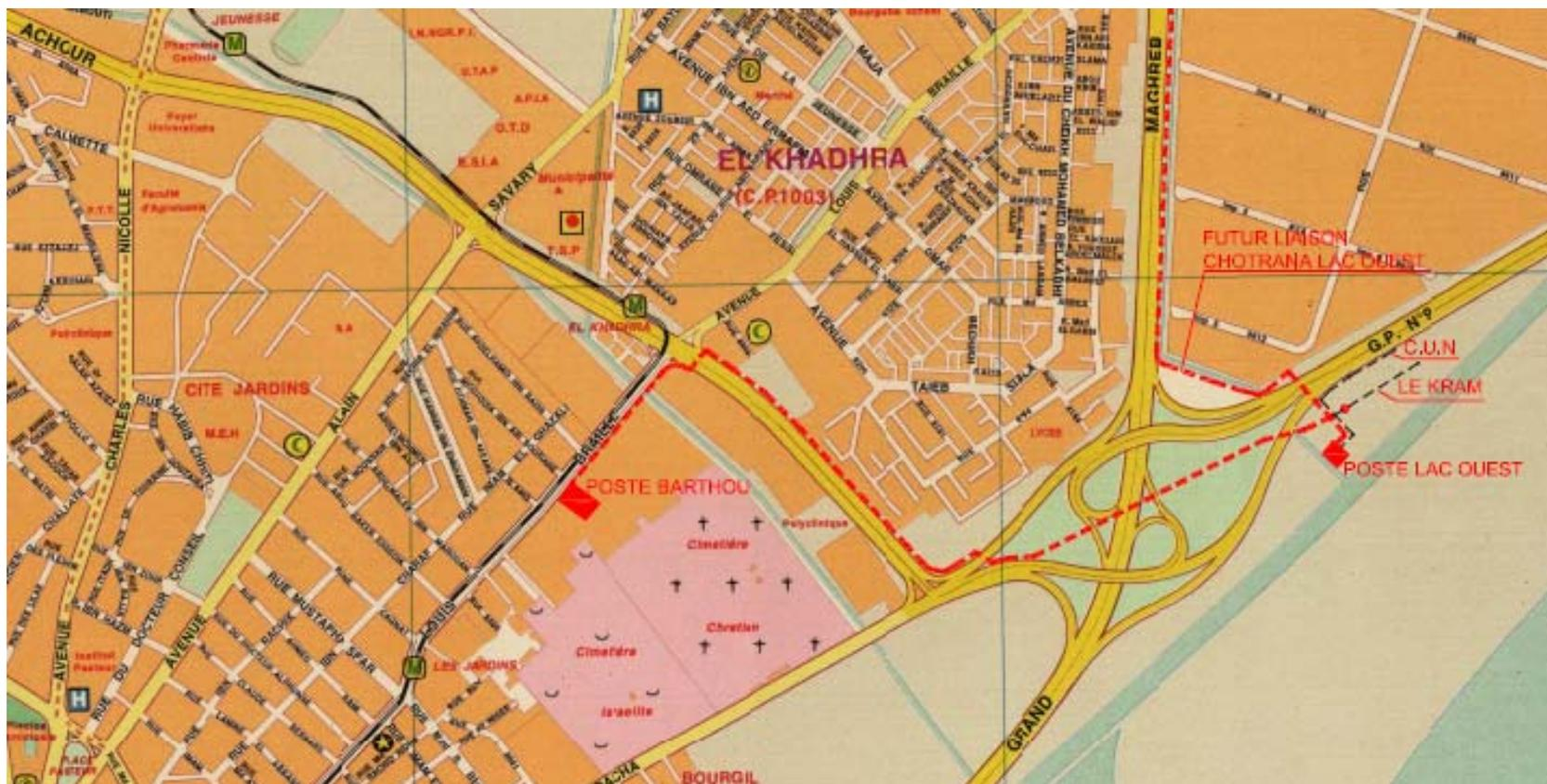
Figure 4 : Tracé de liaison 90 kV Barthou – Lac ouest (2 km)
