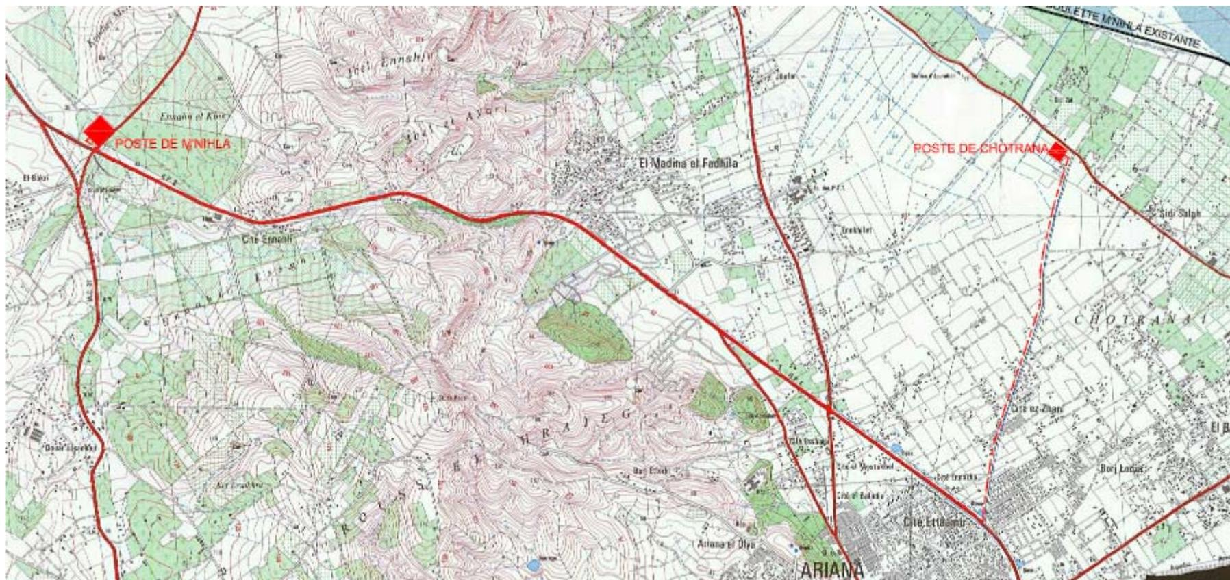
Figure 5 : Tracé de liaison 225 kV – 420 MVA Mnihla –Chotrana (12.8 km)
