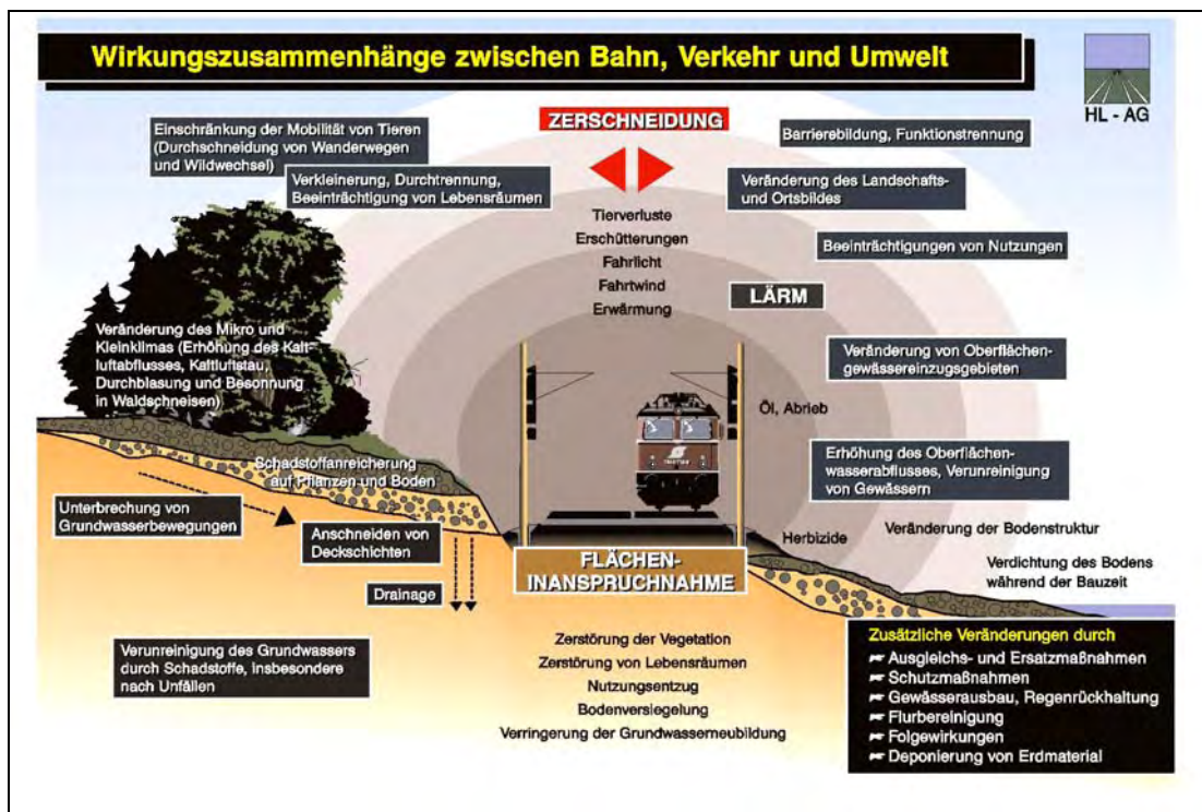
Abbildung 15: Potentielle Auswirkungen einer HL-Strecke auf ihr Umfeld (Quelle: STORM 1988, verändert nach RaumUmwelt PlanungsGmbH)
