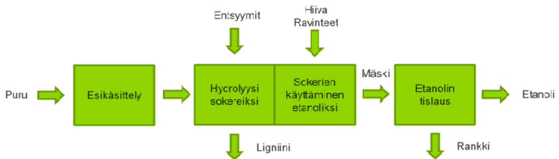
Kuva 2-14. Bioetanolin tuotanto purusta.
