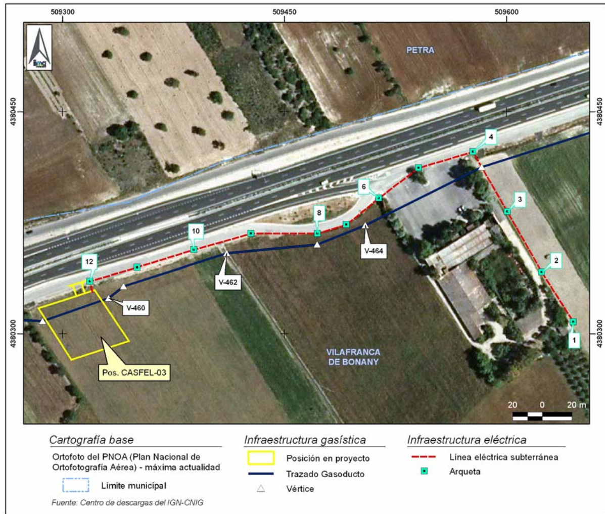
Figura 5.4. Localización de la Acometida a la Pos CASFEL-03 (fuente: IIMAC, 2012)
