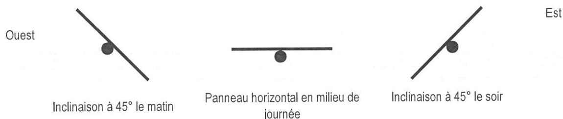
Illustration n° 1 : principe de fonctionnement des trackers
