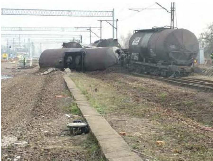
Rysunek 24. Przykład katastrofy kolejowej, w wyniku której dochodzi do wycieku substancji niebezpiecznych z cystern (Raport WIOŚ, 2007).
