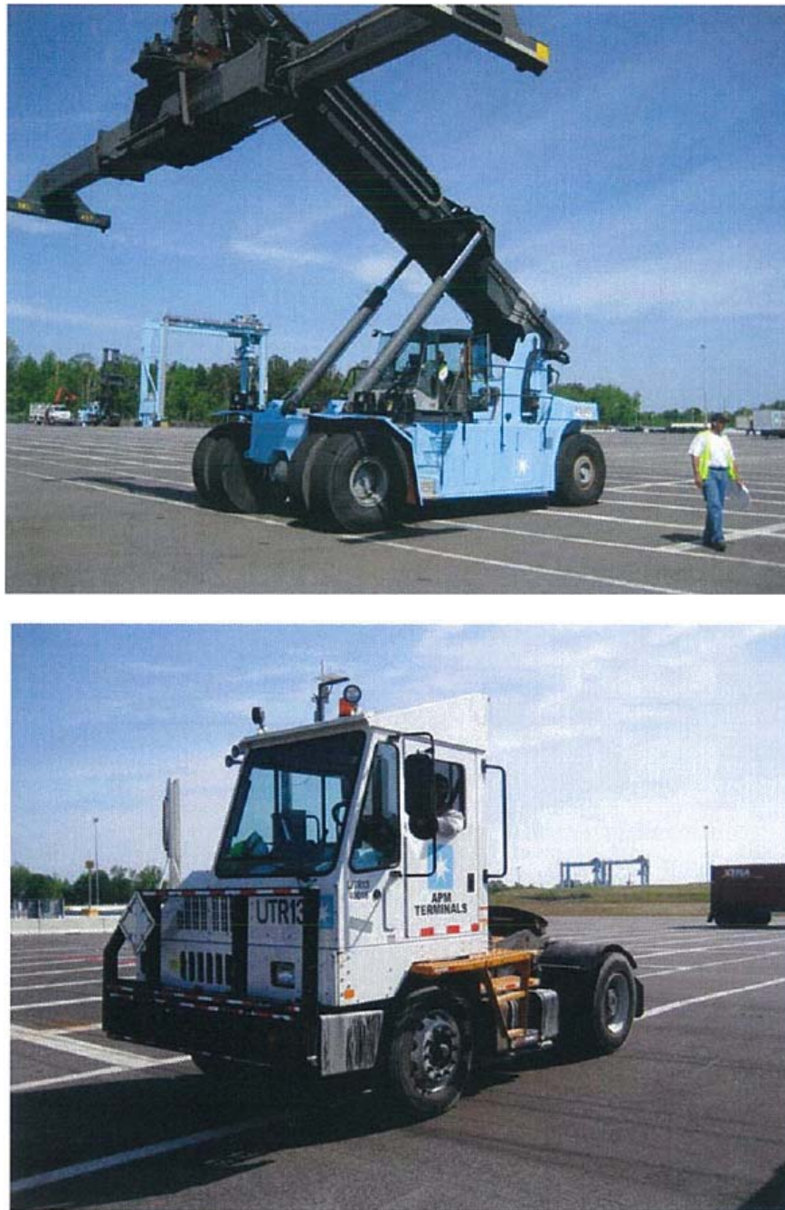
FIGURA 3-5 – IMMAGINI DI “REACH STACKER” E DI “TRACTOR” SIMILI A QUELLI PREVISTI PER IL TERMINAL CONTAINER
