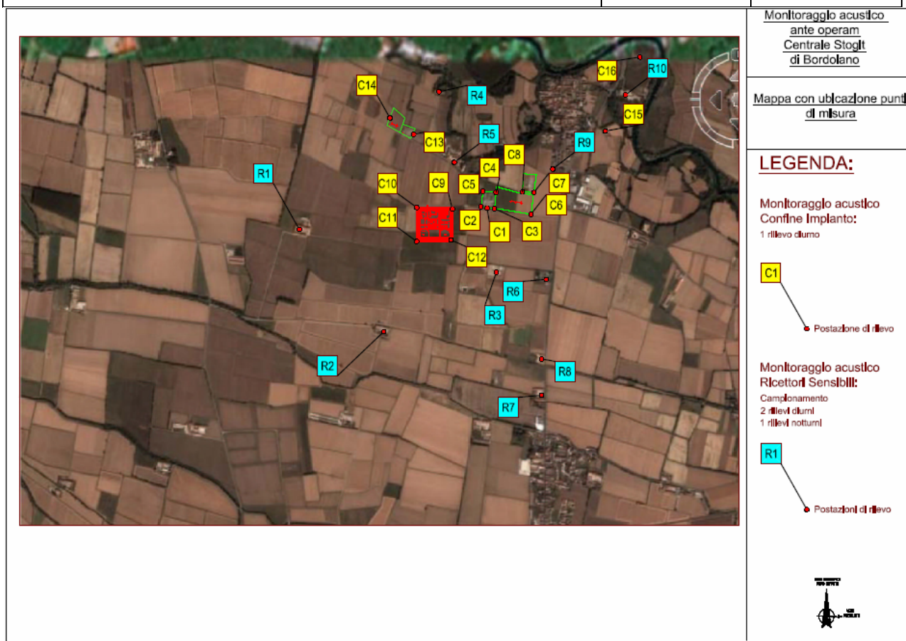
Figura 5.5.2.a - Localizzazione delle postazioni di misura
