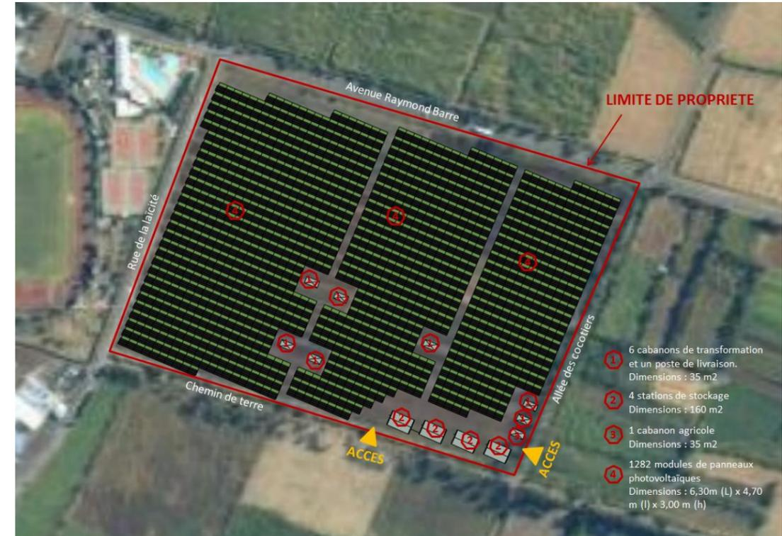
Figure 5-Schéma de la ferme Agrinerie avec l'ensemble de ses composantes
