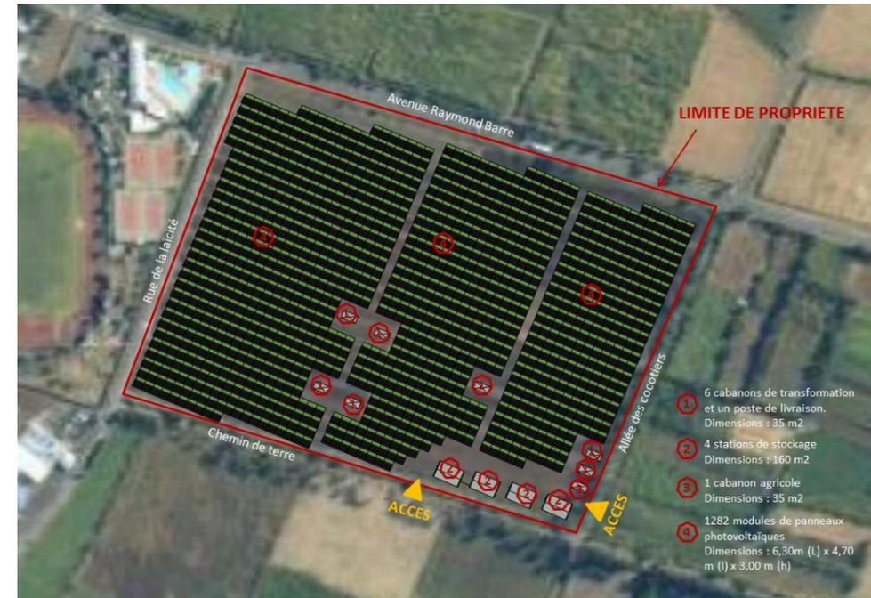
Figure 18 : Schéma de la ferme Agrinergie avec l'ensemble de ses composantes
