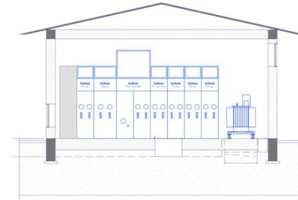
Figure 10 : coupe type du poste de livraison (Source : AKUO ENERGY, 2013)
