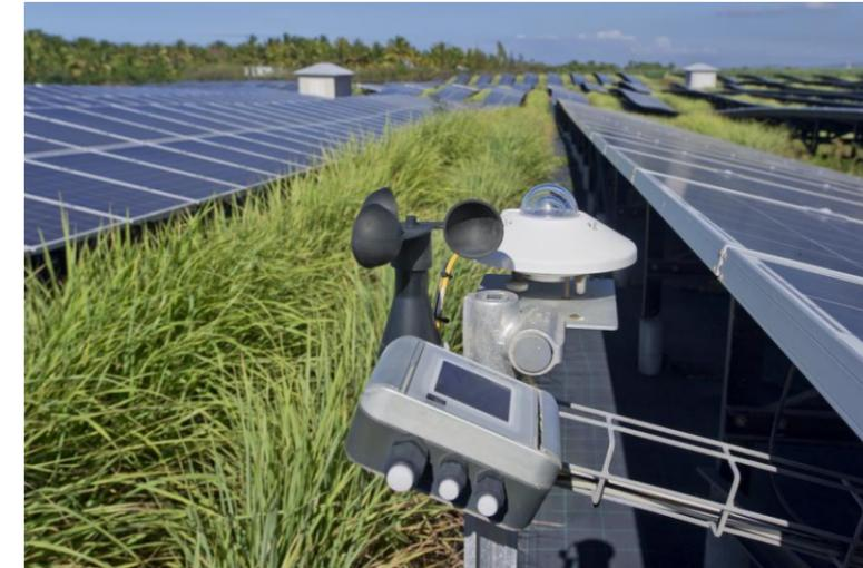
Figure 20 : station d'enregistrement météo (Source : Pierrefonds AKUO ENERGY, 2013)
