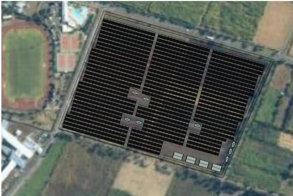
Structure avec 3 panneaux par table, écartement de 2,60m et surélévation des tables pour permettre une mécanisation et la mise en place d'un volet agricole entre et sous ombrières photovoltaïques. Utilisation de la totalité des 7,75 ha permettant de produire 7.5 MW et maintien du projet d'ombrières aquacoles de 1,5 MW.
