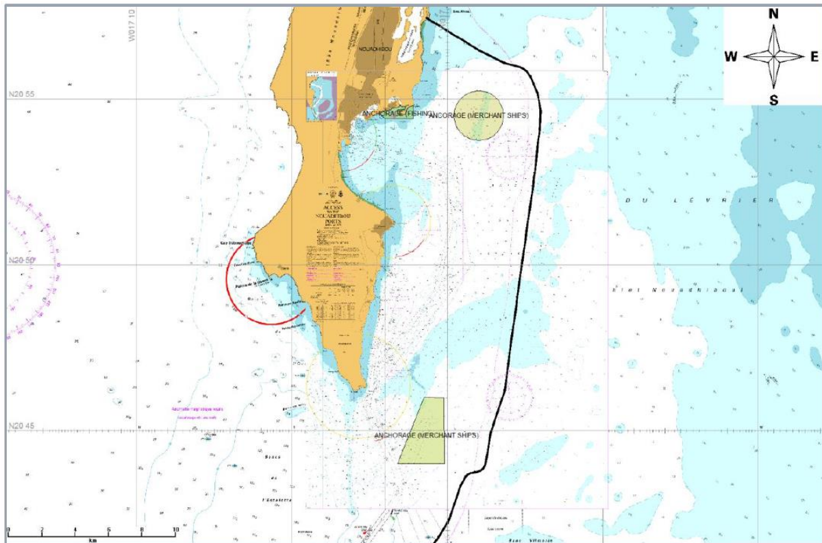
Figure 51 : Zones de mouillage (en vert) au large de Nouadhibou avec la route du câble proposée en noire (UKHO modifié par ASN avec la route de survey, 2025)
