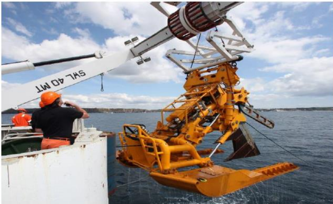
Figure 24 : Exemple de charrue tractée par le navire câblé
