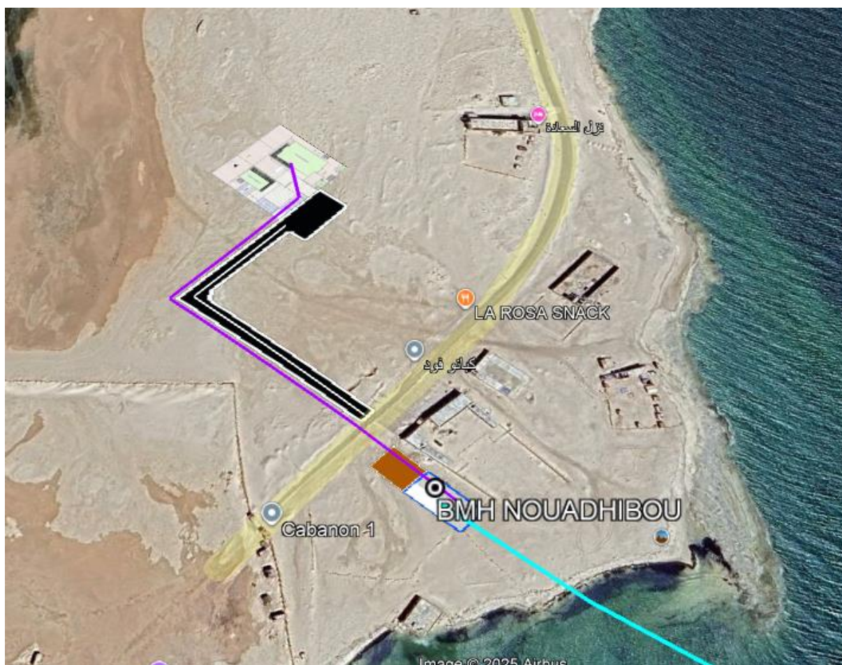
Figure 3 : Vue du site d'atterrissage, avec la localisation de la chambre-plage (BMH) et de la route terrestre prévue du câble jusqu'à la station terminale (CLS) à construire
