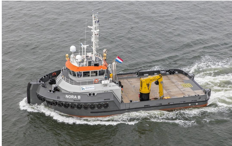
Figure 17 : Exemple de navire utilisable en eaux peu profondes pour les travaux d'atterrissement (OMS - Optic Marine Services)
