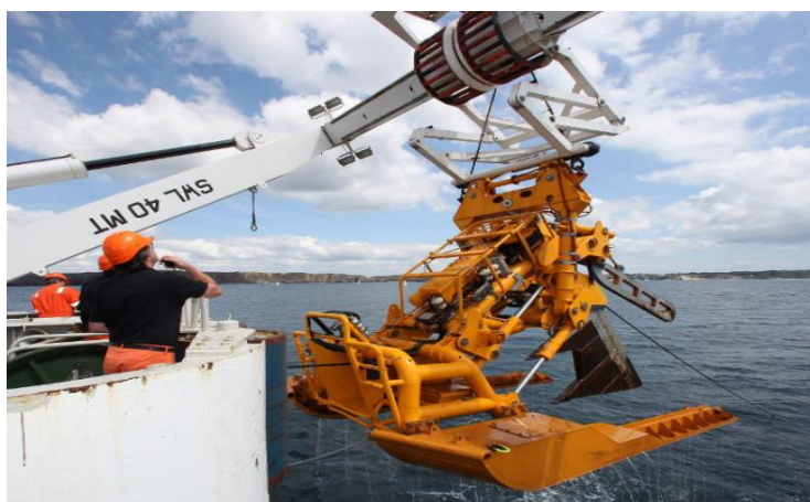
Figure 9: Exemple de charrue tractée par le navire câblé
