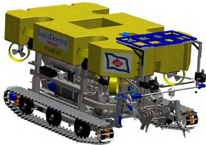
Figure 25 : ROV d'ensouillage par jetting prévu pour opérer jusqu'à 1500 mètres (Louis Dreyfus TravOcean ROVJet 550)
