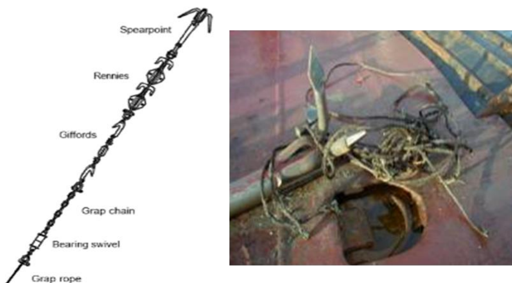
Figure 7 : Illustrations d'un grapin pour l'opération de nettoyage de la route
