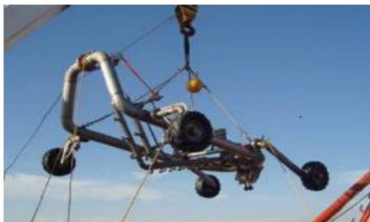
Figure 10 : Exemple d'outil d'ensouillage manuel utilisé par des plongeurs
