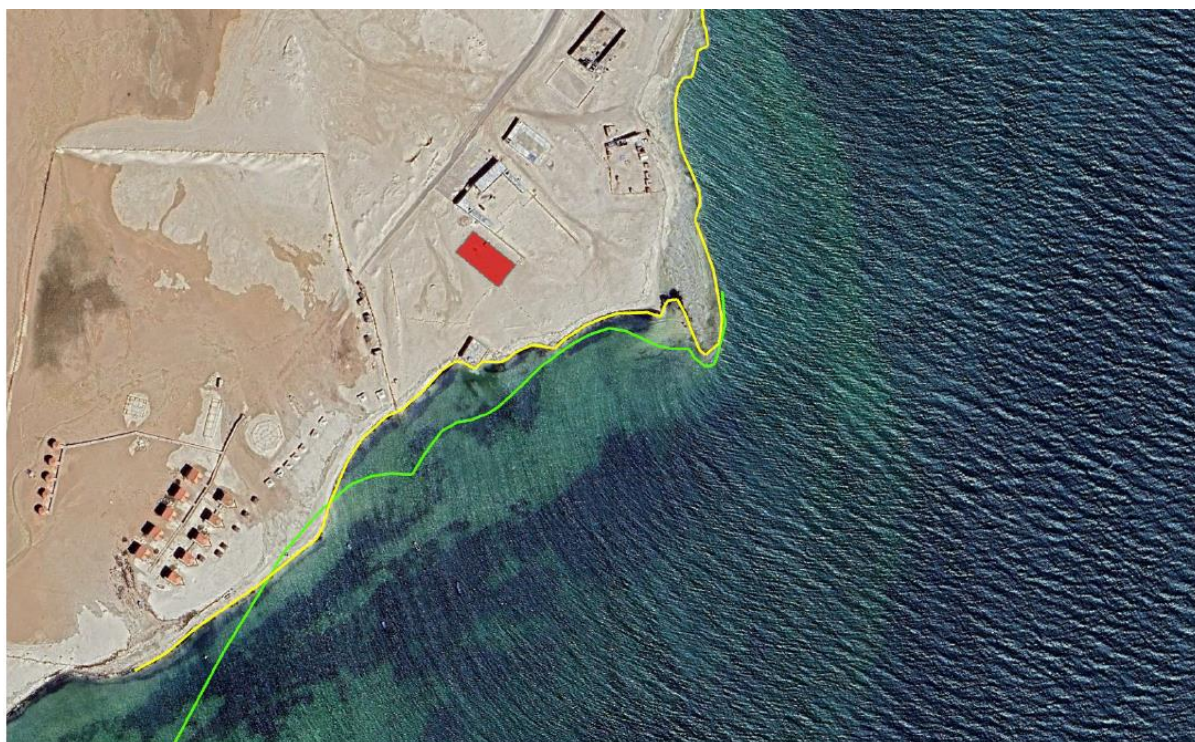
Figure 34 : Evolution du trait de côte au niveau du site d'atterrissage (rectangle rouge) avec la ligne jaune représentant la situation actuelle (mars 2025) et la ligne verte celle en 2012 (ASN, 2025)
