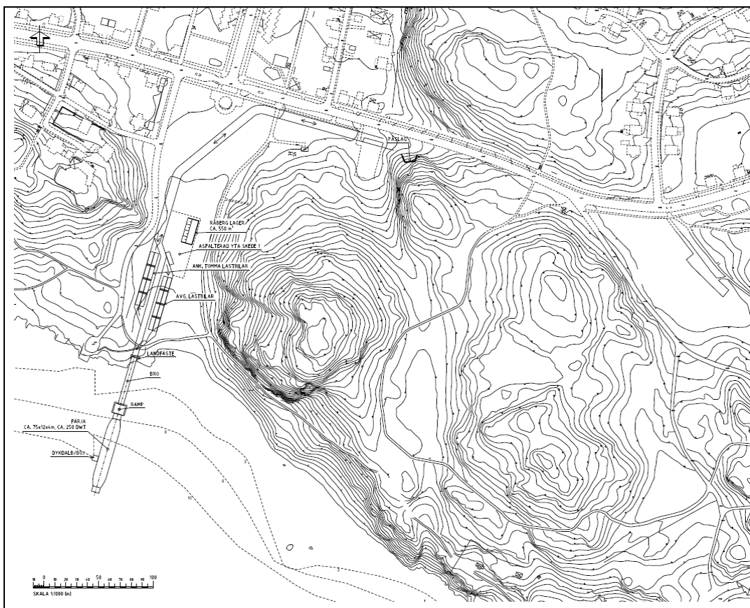
Figur 5.8 Förslag till tillfällig utlastningshamn vid Smedslätten för färja, fast ramp, skede 1 och skede 2 (se även ritning 8)
