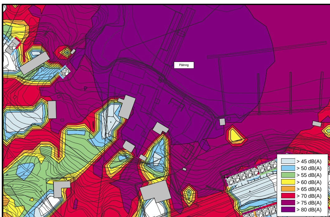
Figur 18. Ljudnivå under pågående pålning (slagna stålrörspålar betongpålar) under anläggningsskedet. Ekvivalent ljudnivå 2 m ö mark.
