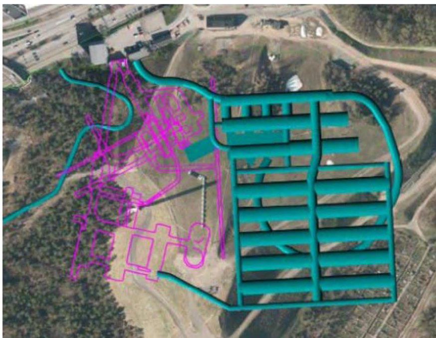
Figur 3.4 Den befintliga anläggningen visas i magentafärg och den planerade utbyggnaden i turkos. Lokalisering av nya bergutrymmen vid Sickla. Lokaliseringen är i huvudsak under Hammarbybacken. Båda anläggningarna kommer att vara i drift i framtiden.
