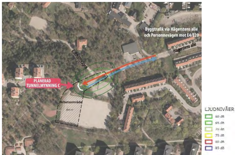
Figur 6.32 Ljudutbredning runt etableringsytan vid Eolshäll. Kartan visar ekvivalent ljudnivå inklusive fasadreflex.
