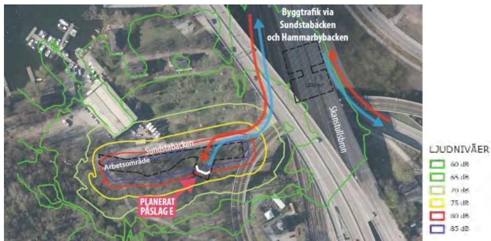
Figur 6.35 Ljudutbredning runt etableringsytan vid Gullmarsplan. Kartan visar maximal ljudnivå inklusive fasadreflex.
