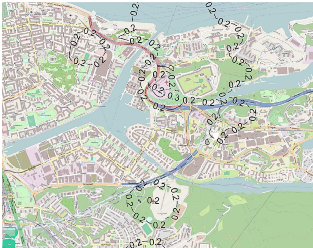
Figur 7-4 Scenario 3. Omgivningshalter av lukt kring Sickla och Henriksdal vid fullt utbyggda anläggningar med rening av frånluft från sandfång/grovrens samt mottagning av organiskt avfall. Resultaten avser 1,5 m höjd ovan mark.
