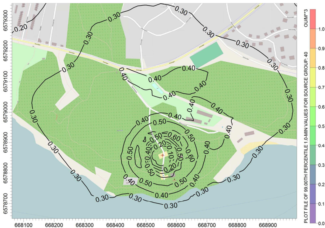
Figur 6-4 Scenario 3. Luktemission 37 Ml.e./h vid flödet 10 000 m 3 /h och höjden 40m.
