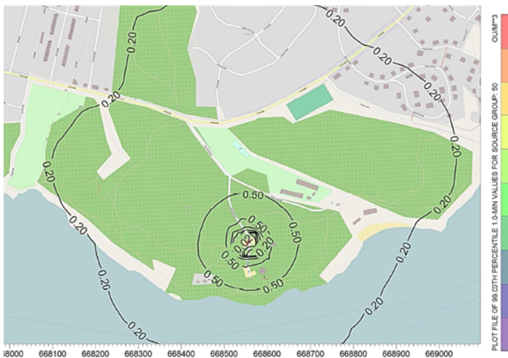
Figur 6-12 Scenario 11 Luktemission 37 Ml.e./h vid flödet 1 000 m 3 /h och höjden 50m.
