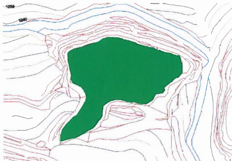
Σχήμα 4.1-2: Τελική διαμόρφωση χώρου εσωτερικής απόθεσης στείρων
