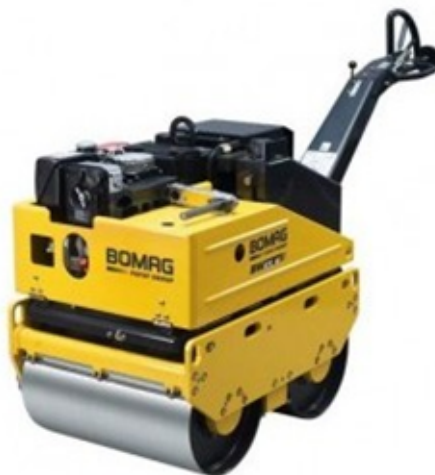
Figure 8 : Rouleau compresseur duplex
