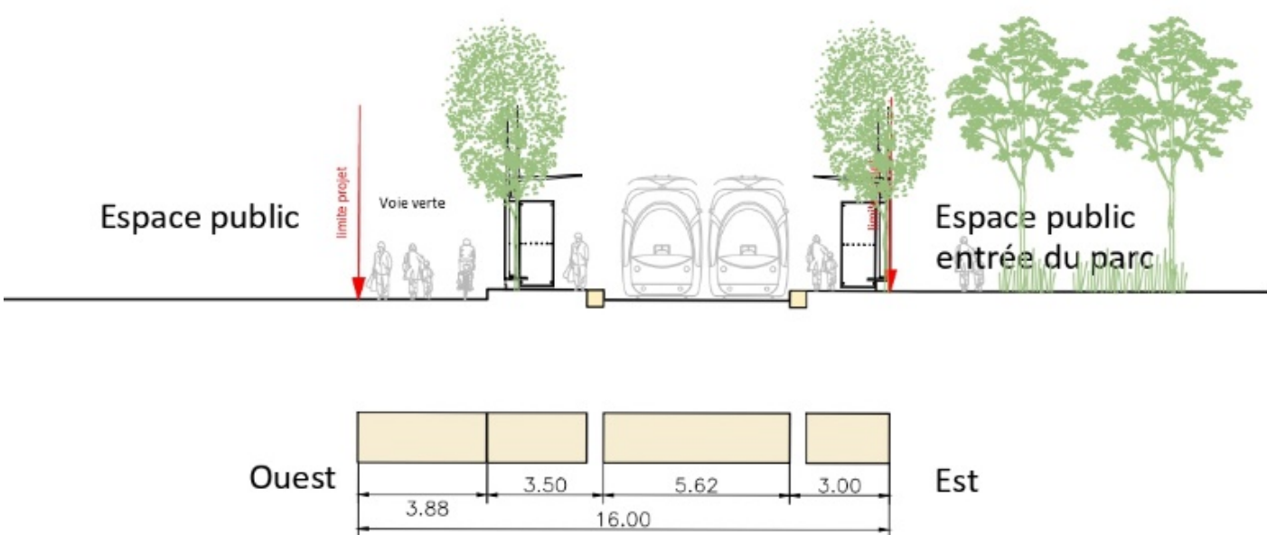
Figure 72 - Profil en travers envisagé dans le secteur ACI envisagé (B-B')
