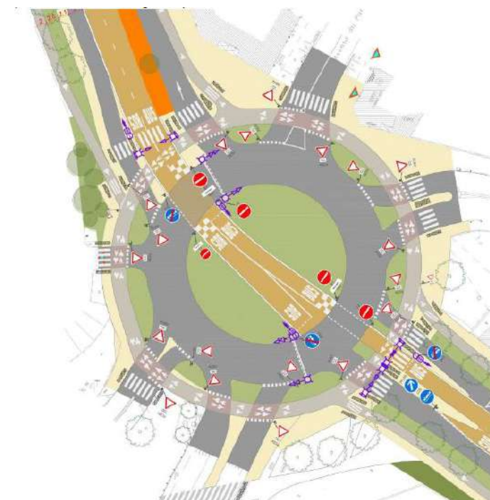
Figure 116 : Giratoire Canolle / Bourdelle - percé avec piste cyclable bidirectionnelle prioritaire
