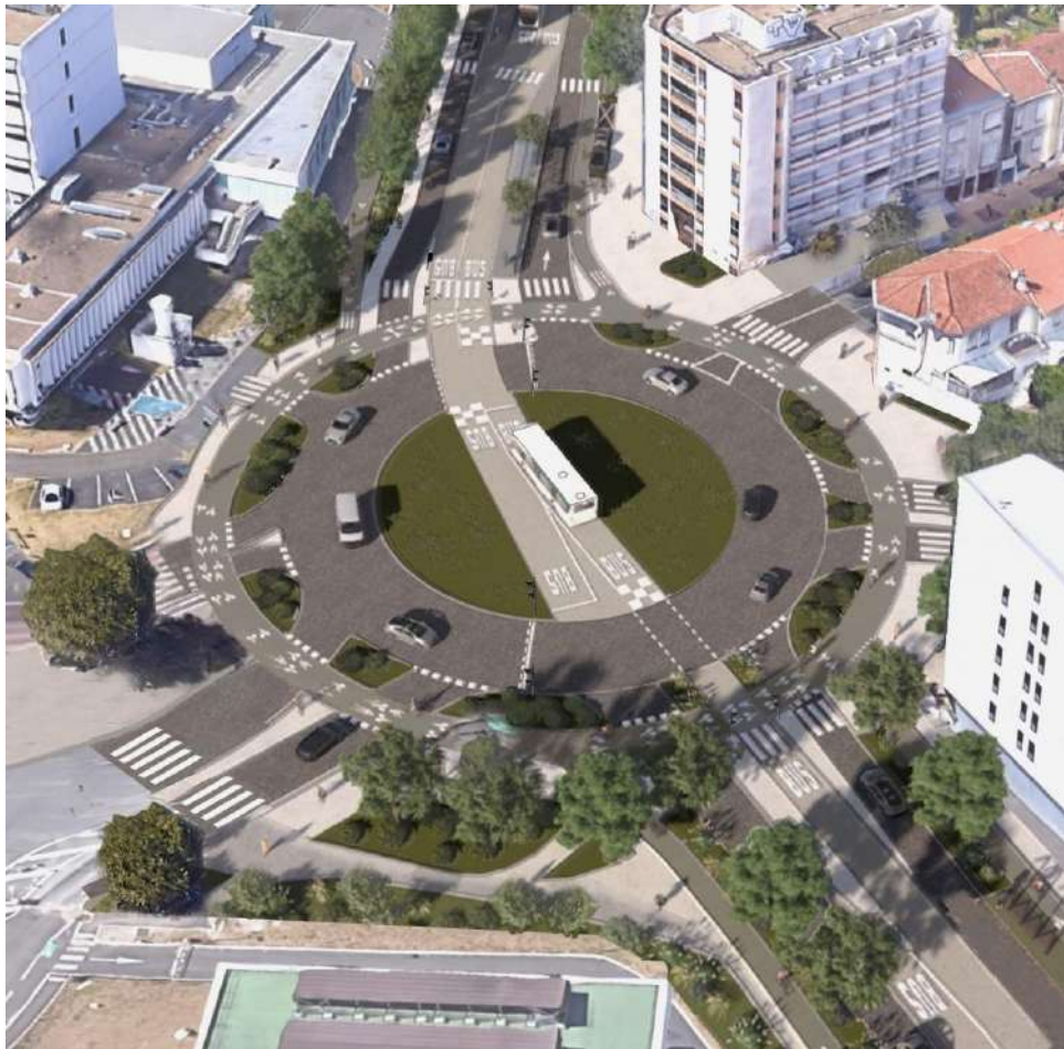
Figure 27: Exemple de giratoire percé à priorité bus
