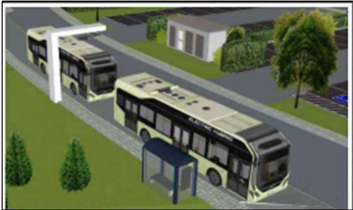
Figure 121 : Exemple de charge semi rapide au terminus. Photo non contractuelle
