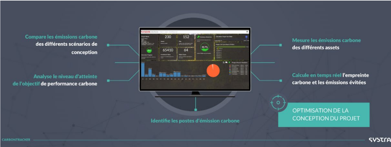
Figure 9 CarbonTracker : Outil de suivi carbone développé par Systra
