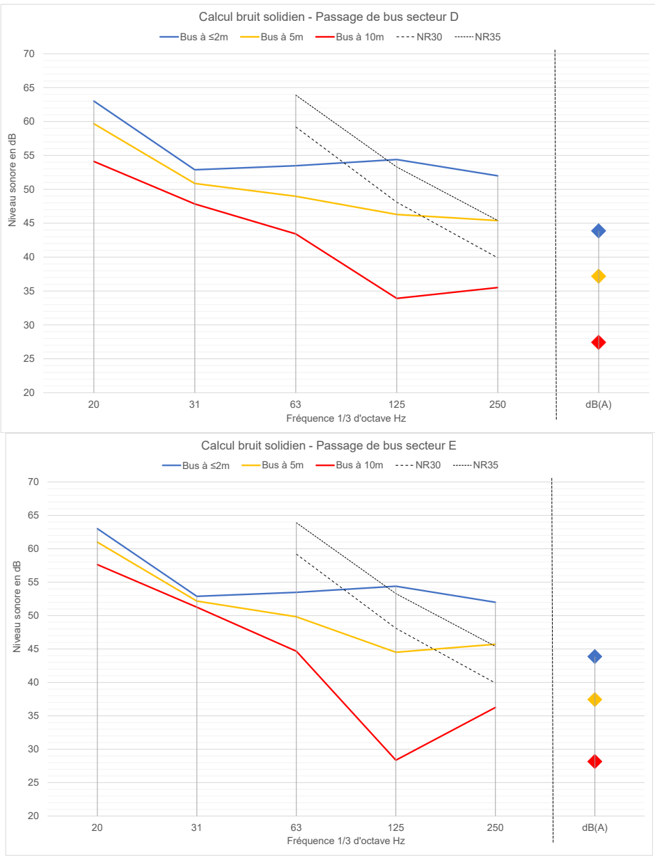
Figure 96: Bruit solidien calculé au passage de bus pour chaque secteur – Source : SIXENSE
