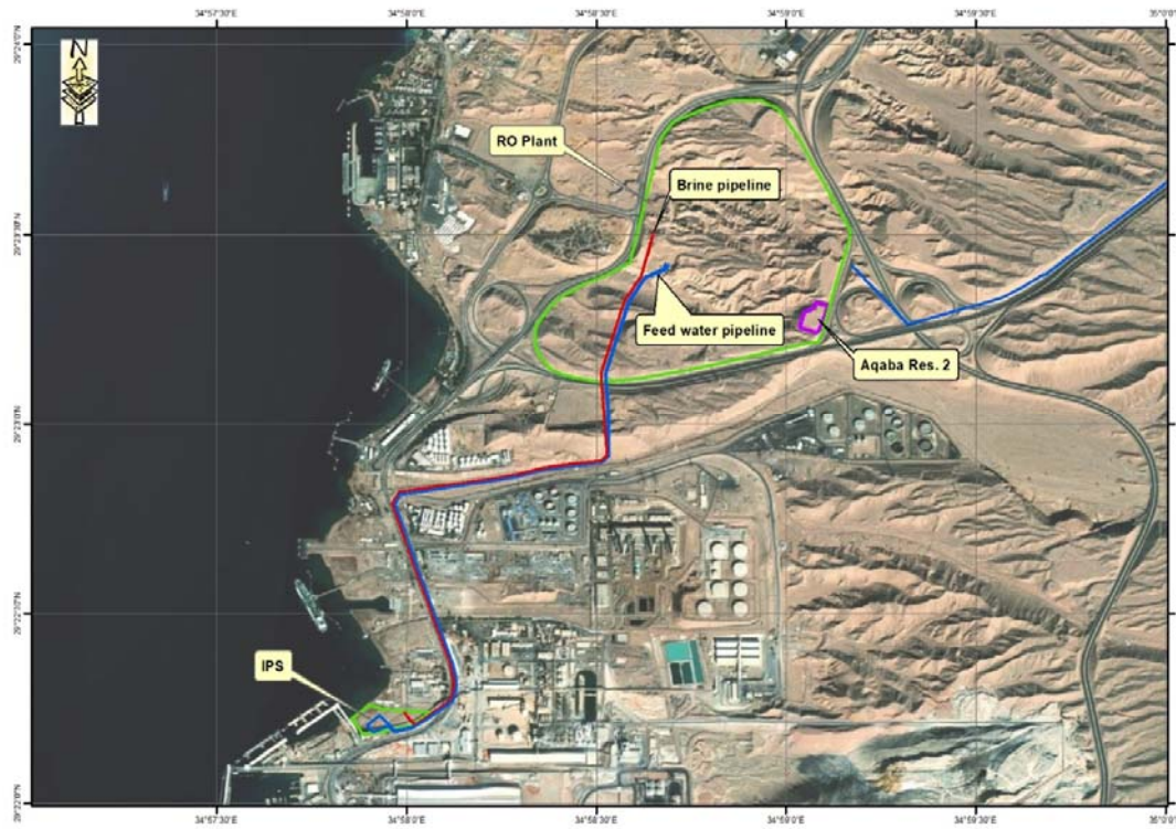
الشكل 4: خط تصريف المحلول الملحي من محطة SWRO إلى محطة IPS
