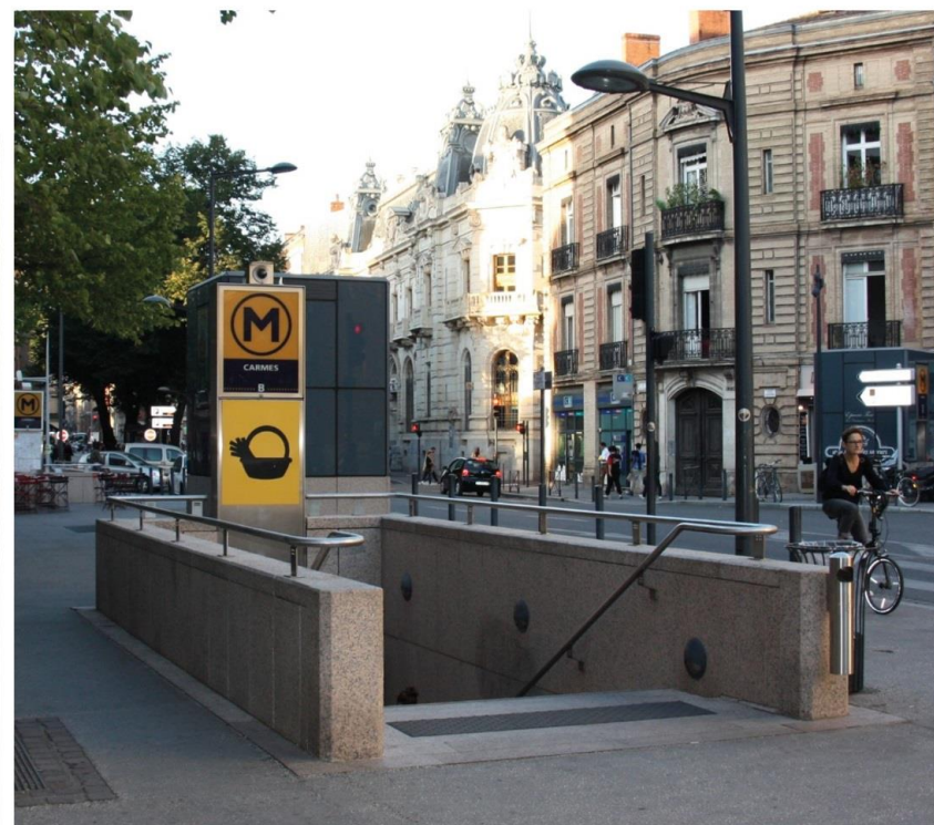
△ La présence de la station sur le sol de l'espace public est minimal, avec une bordure périphérique de 20cm en granit rose. Le matériau de sol est conservé en fonction de son contexte local et urbain.
