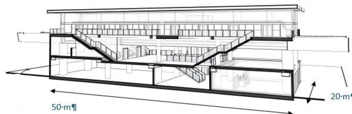
Schéma de principe des stations de type A1 en coupe 3D
